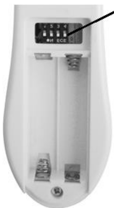
Imagen 11 Compartimento de las pilas del mando a distancia Conjunto de interruptores DIP del receptor
