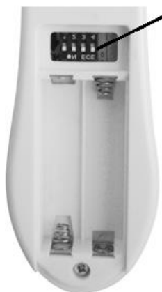
Fig. 11 Vano batterie del telecomando
