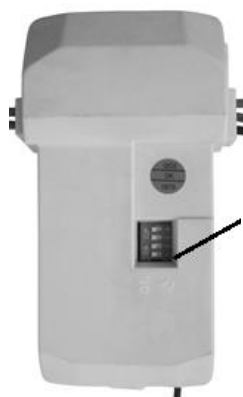
Imagen 11 Compartimento de las pilas del mando a distancia Conjunto de interruptores DIP del receptor
