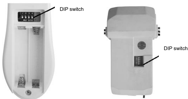
Fig. 11 Vano batterie del telecomando
