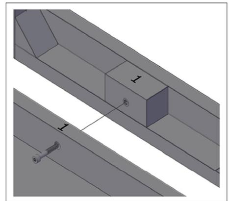
3. Fixieren Sie alle Schrauben einer Tischseite zunächst leicht, erst dann die schrauben fest anziehen.
